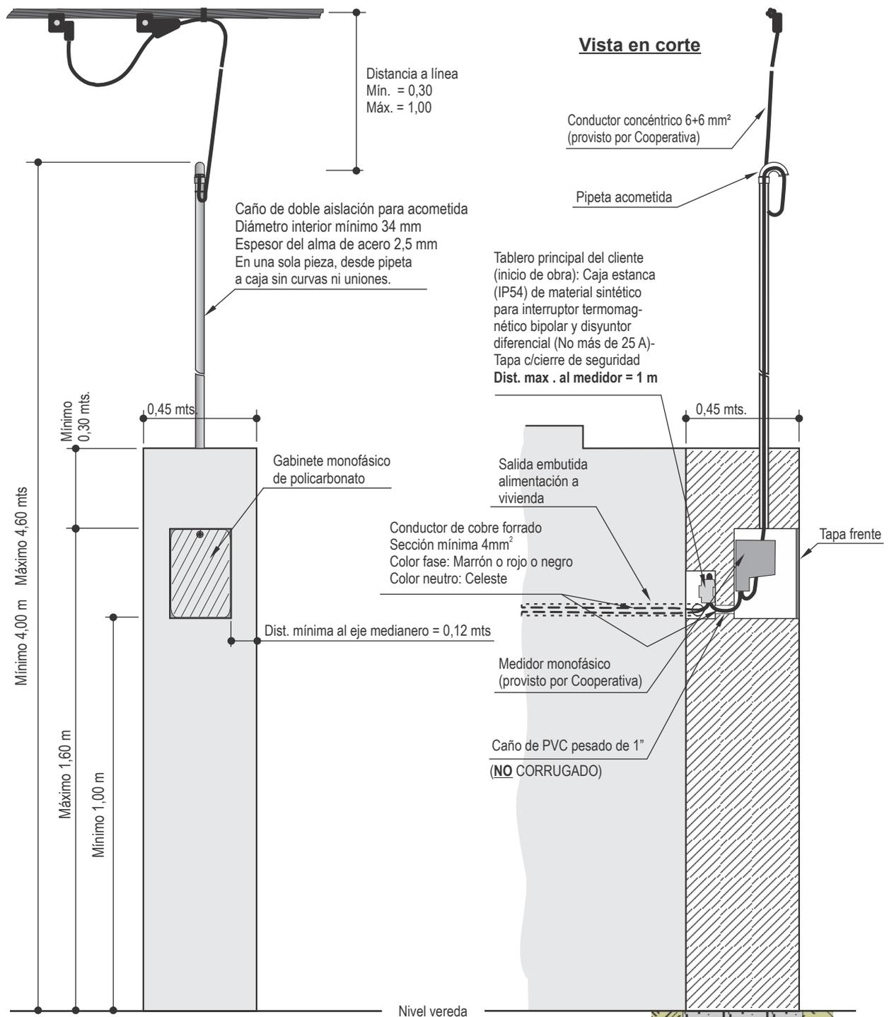
En aquellas acometidas en las que el caño de bajada quede embutido en la pared, al momento de la inspección deberá estar visible el sector del caño donde pueda leerse la **MARCA** y **MODELO** del mismo, permitiendo comprobar así que sea un caño aprobado por la Cooperativa. Luego de la inspección, se deberá revestir por completo.-
